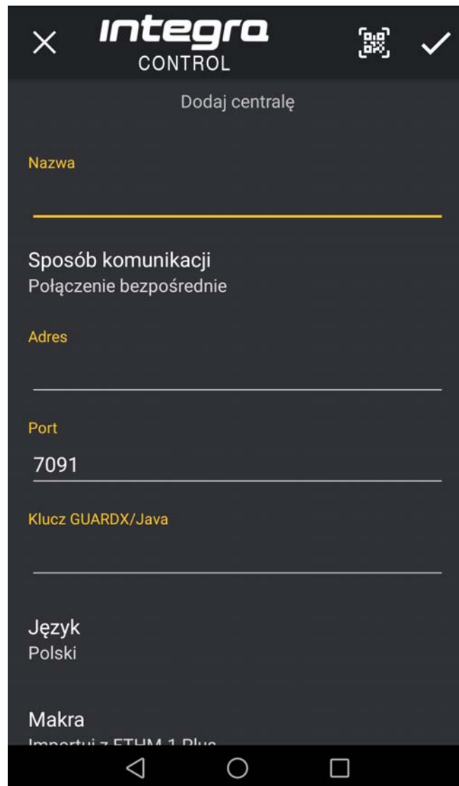
Rys. 21. Aplikacja INTEGRA CONTROL (system Android): ekran „Dodaj centralę”.
