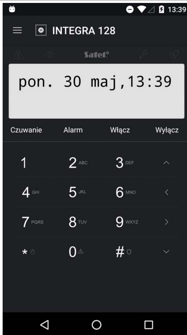
Rys. 23. Aplikacja INTEGRA CONTROL (system Android): wirtualny manipulator.
